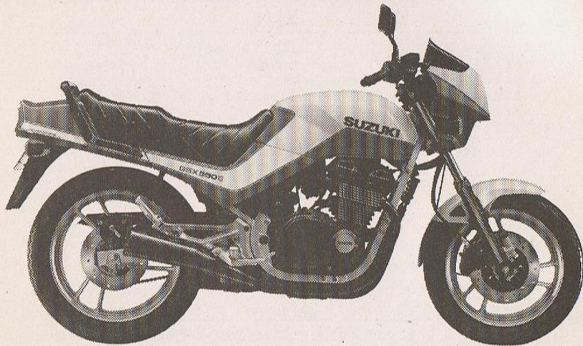
4 Zylinder, 4-Takt, 50 PS/37 Kw bei 9.600 min.<sup>-1</sup>, 16 Ventile (TSCC), 6 Gänge, kontaktlose Zündung, 170 km/h.
